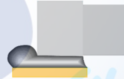
(c) 焊錫浸潤不足
